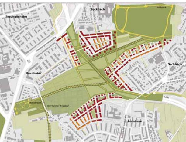
Maximaler Lärmschutz und optimale stadträumliche Verflechtung werden durch diese städtebauliche Planungsalternative erreicht, die eine Komplettinhausung der A 661 zwischen Bornheim und Seckbach vorsieht. Bild: ASP
